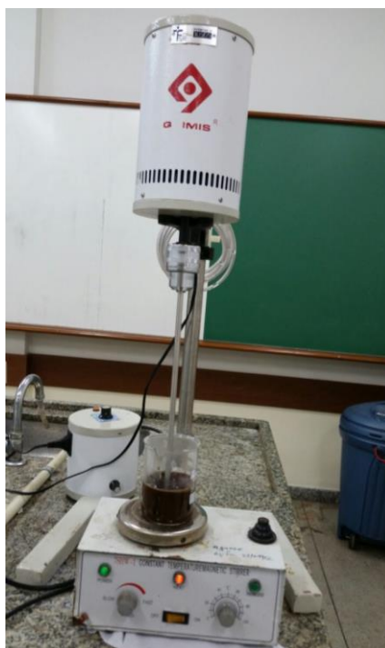
Figura 3 – Esquema com manta de aquecimento, béquer e agitador mecânico
