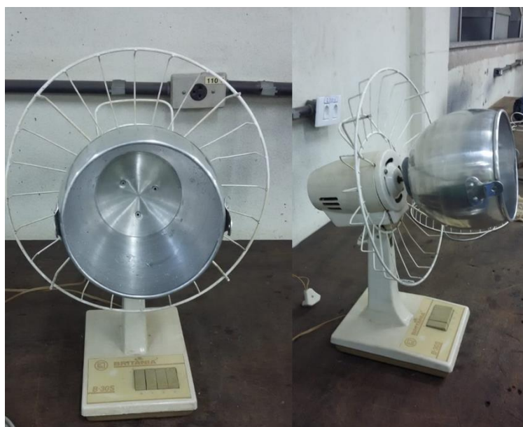
Figura 4 – Equipamento confeccionado para homogeneização da ureia
